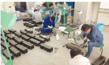
ポラスコンクリートブロックの脱型作業
